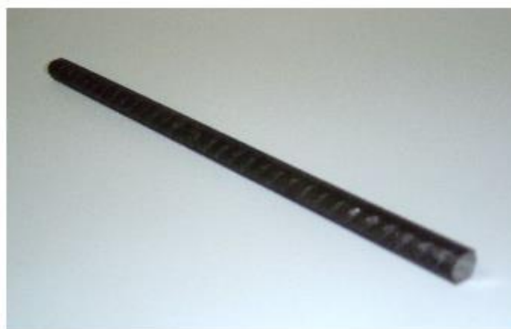
Figura 7: Barra de aço de construção de 8 mm de diâmetro
