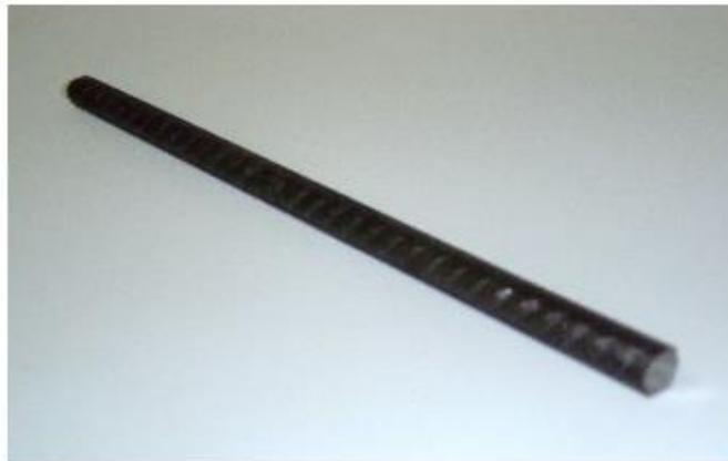
n) A carga aplicada será transmitida à ponte através desta barra, sendo nelas fixados ganchos com os pesos, o peso do gancho fará parte do carregamento;
